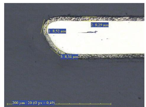
*Querschliff durch die galvanisch Nickel-dispersionsschicht **DIAGLIDE®** mit eingelagerten Nanopartikeln (links) und einer chemisch Nickel-Phosphor-Schicht mit eingebautem Siliziumcarbid (SiC) und sehr guter, konturtreuer Schichtverteilung (oben)*
